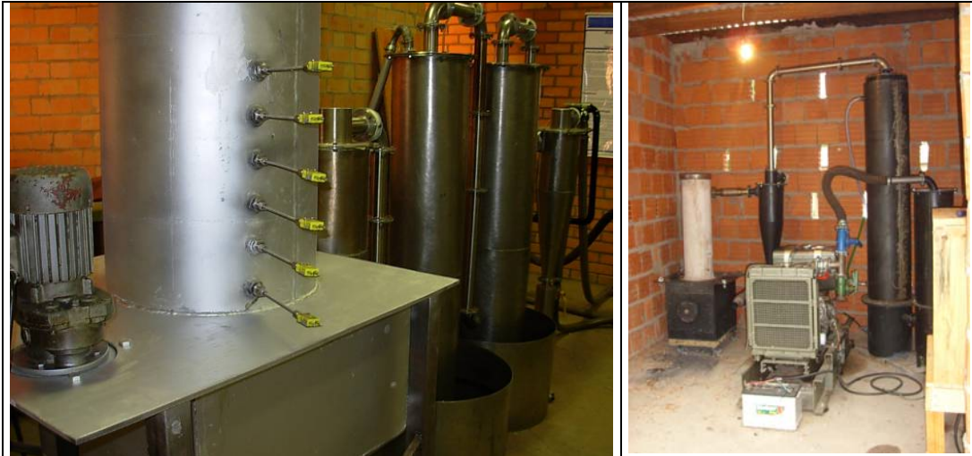
Figura 5 - Gaseificador experimental no LEA e planta demonstrativa de 15 kVA em campo. Fonte – Laboratório de Energia e Ambiente Departamento de Engenharia Mecânica UnB.
