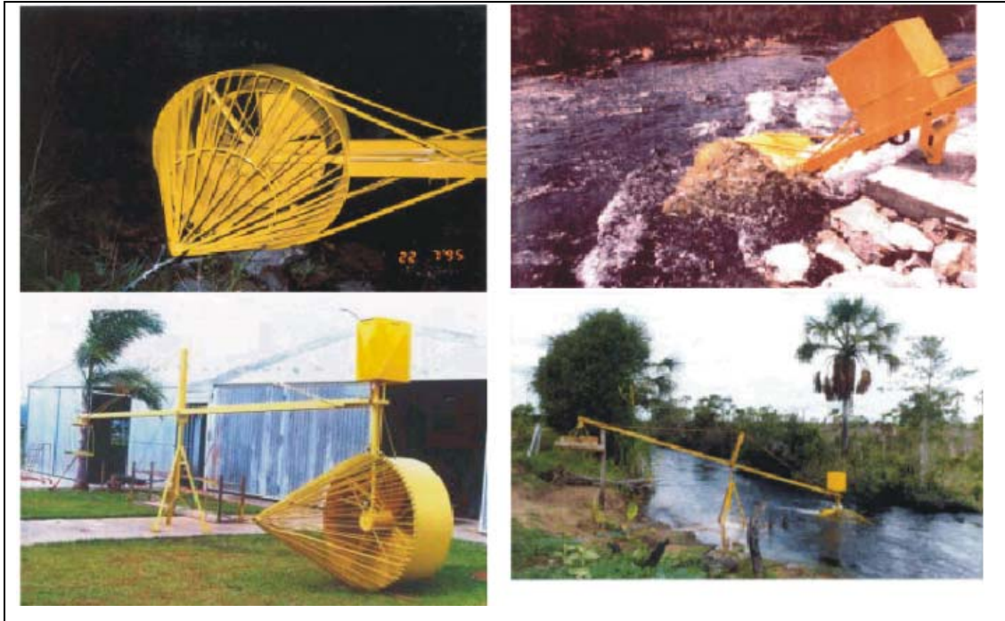
Figura 8 - Turbinas hidrocínéticas da primeira geração no Município de Correntina – BA Fonte: Els et al., 2003
